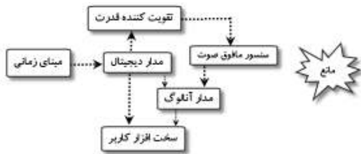
شکل ۱: بلوک دیاگرام سیستم اندازه‌گیری فاصله
